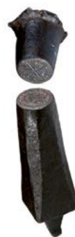
Figure 12. Une paire de coins monétaires gravés. En haut : Coin mobile ou pile avec gravure de l'avers. En bas : Coin fixe ou trousseau.
