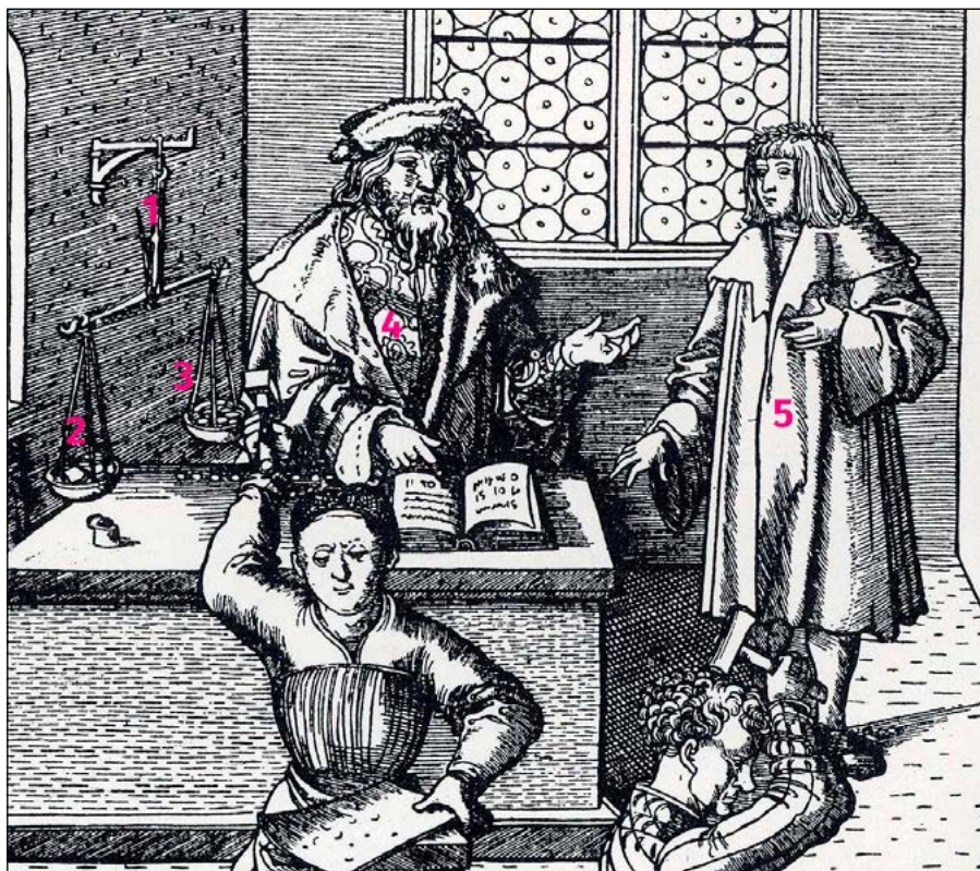
Figure 14. Le contrôle final. 1. Trébuchet. 2. Plateau avec poids monétaires ou dénéraux. 3. Plateau avec une série de pièces. 4. Garde tenant le livre des contrôles. 5. Maître vérificateur.
